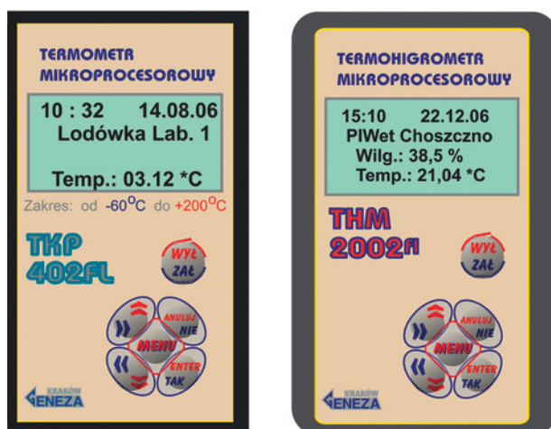
Rys. 2. Przykładowy termometr i termohigrometr mikroprocesorowy o parametrach technicznych pozwalających na walidację innych przyrządów użytkowych
