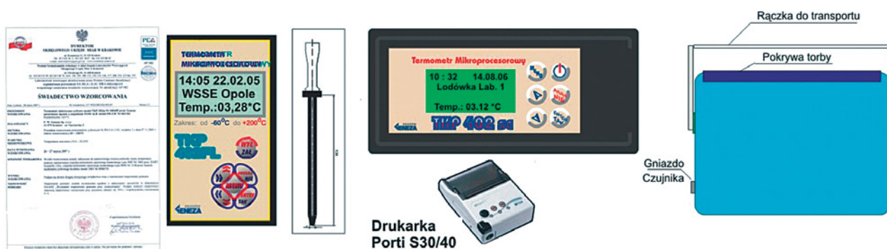
Rys. 7. Przykładowy zestaw przyrządów do monitoringu warunków transportu próbek wrażliwych. Zapisane w pamięci termometru wyniki rejestracji temperatury transportu mogą posłużyć do stworzenia bazy danych przewożonych materiałów wrażliwych
